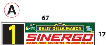
11.BIS.1.2 Ogni pannello sarà applicato in orizzontale sul bordo d'attacco di ogni portiera anteriore, **il numero sul davanti**. La cima del pannello dovrà trovarsi fra 7 e 10 cm. al di sotto del limite inferiore del finestrino.
