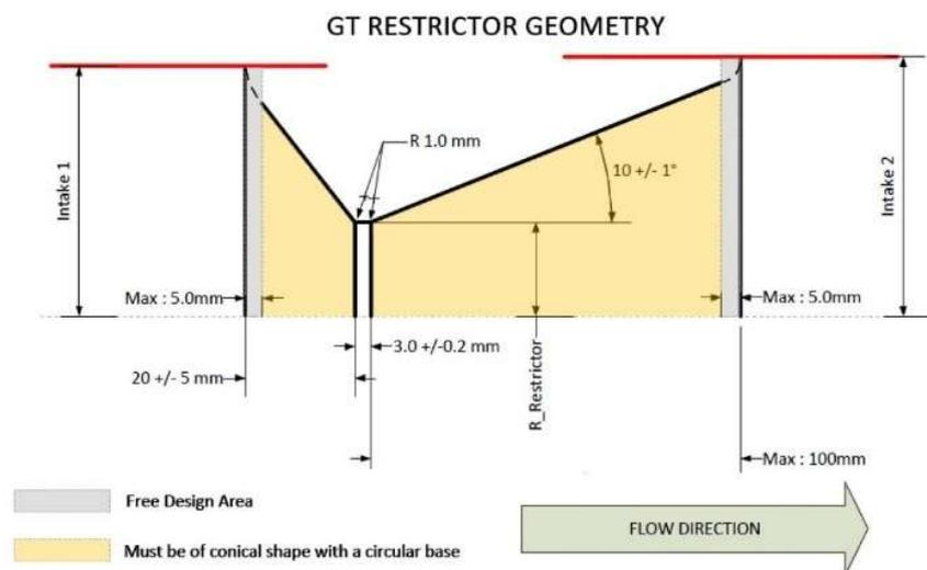
Fig. 1 – Specifiche geometriche dei restrittori / Restrictor geometry definition
